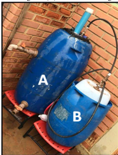
Figura 3 – Biodigestor (A) e reservatório de gás (B).
