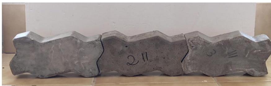
Figura 6 – Fotografia dos bloquetes nas formas de 16 faces 24x10x8 cm, do 28º dia de cura, associados aos traços T_1 , T_2 e T_3 , nessa respectiva ordem, da esquerda para direita.
